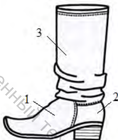
Рисунок 4.5 – Наружные детали заготовки сапога: 1 – союзка; 2 – задинка; 3 – голенище
