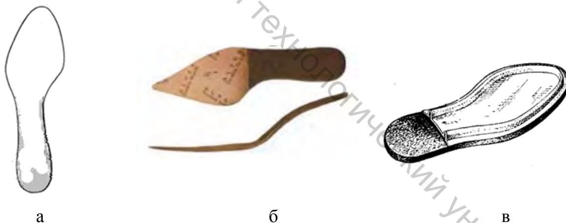
Рисунок 4.16 – Основная стелька: а – плоская, б – формованная, в – рантовая
