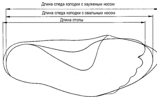
Рисунок 3.2 – Зависимость длины следа колодки от формы носочной части колодки
