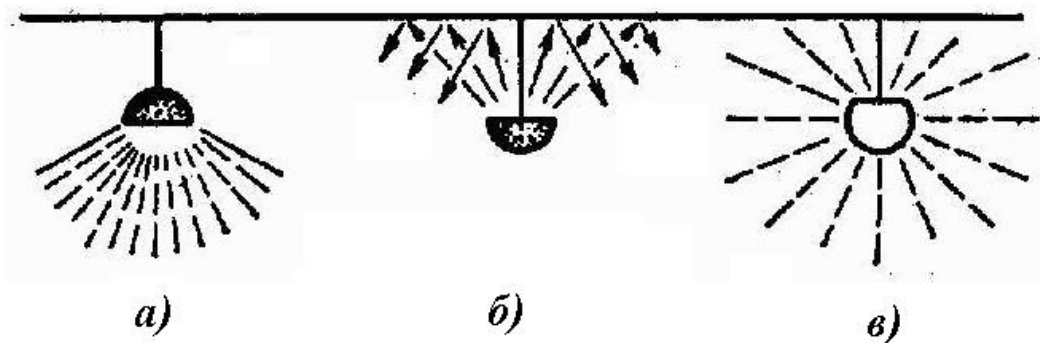
Рисунок 3.2 – Распределение светового потока в светильниках: а – прямой и преимущественно прямой; б – отраженный и преимущественно отраженный; в – рассеянный
