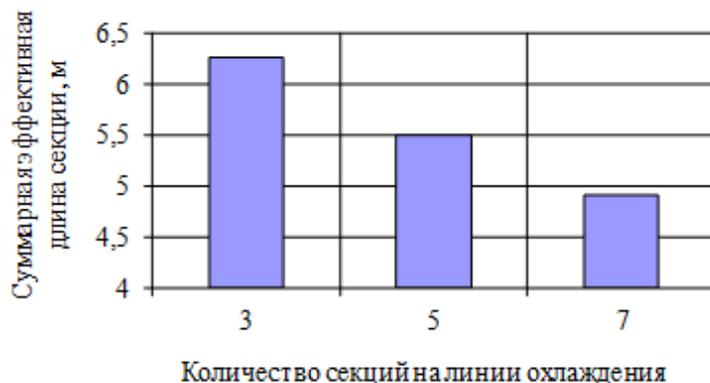
Рисунок 8 – Зависимость суммарной эффективной длины секций от общего количества секций на линии охлаждения
