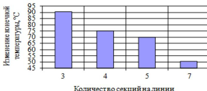
Рисунок 13 – Изменение температуры проката на виткосборнике при выключении одной из секций из общего количества
