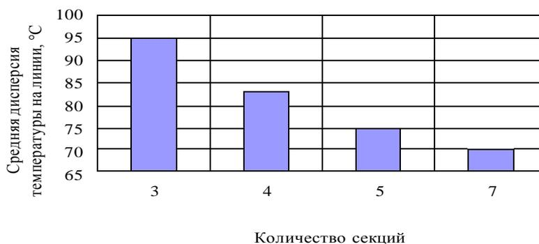
Рисунок 10 – Средняя дисперсия температуры для линий с различным числом секций
