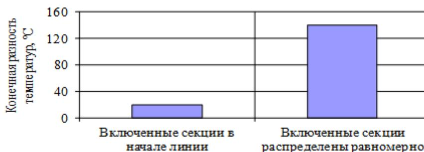
Рисунок 11 – Конечная разность температур при различных наборах включенных секций охлаждения
