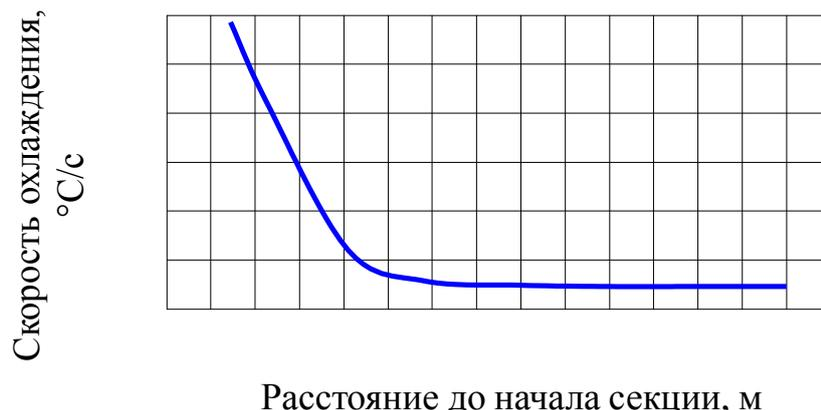
Рисунок 4 – Скорость изменения температуры при прохождении включенной секции №1
