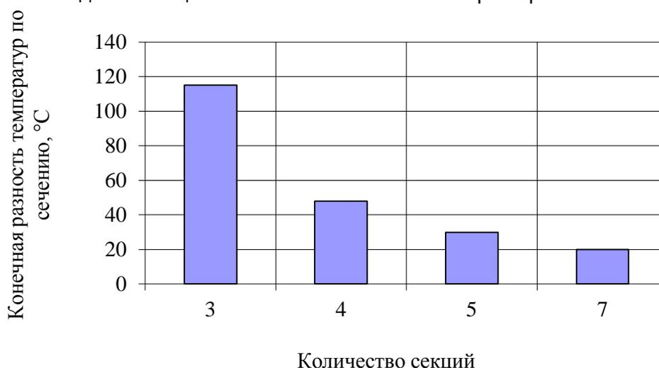
Рисунок 9 – Конечная разность температур по сечению катанки для линии с различным числом секций
