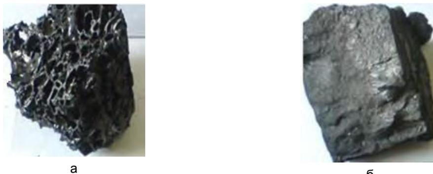
Рисунок 9 – Внешний вид коксовых матриц, полученных при различных режимах карбонизации
