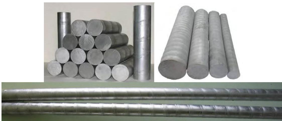
Рисунок 9 – Непрерывнолитые заготовки из СГК
