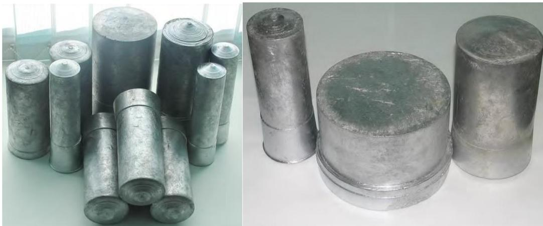
Рисунок 6 – Заготовки из СГК, полученные литьем в струйные кристаллизаторы
