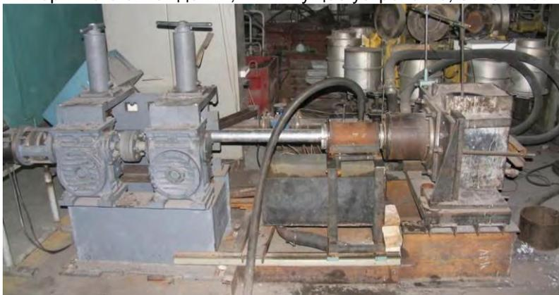
Рисунок 8 – Непрерывное горизонтальное литье с использованием струйного охлаждения
