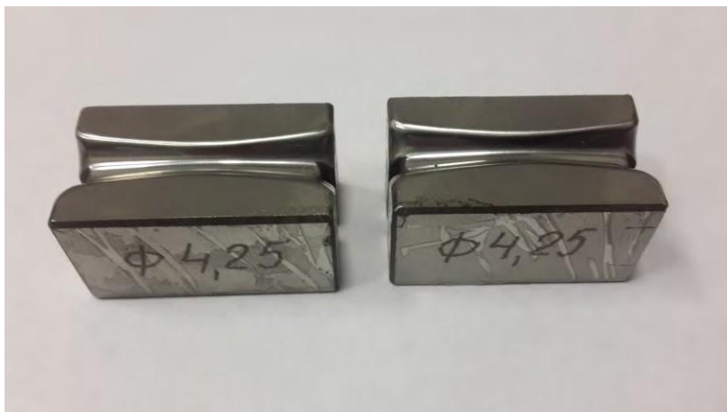
Рисунок 6 – Ковочные рабочие стальные бойки диаметром. 4,25 мм на РКМ-3
