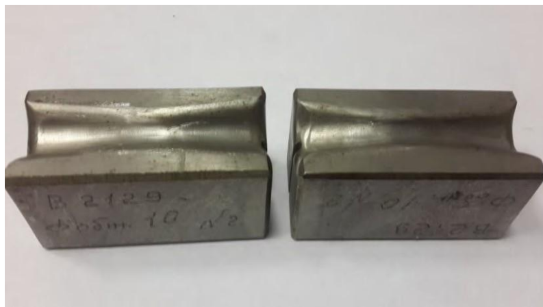
Рисунок 5 – Ковочные рабочие стальные бойки диаметром 10 мм на РКМ-1
