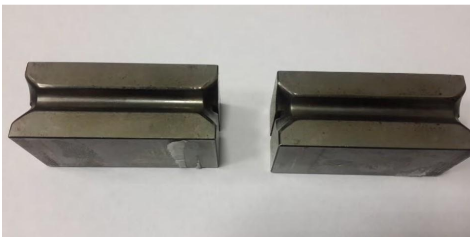
Рисунок 7 – Ковочные калибровочные стальные бойки диаметром. 7, 5 мм на РКМ-2
