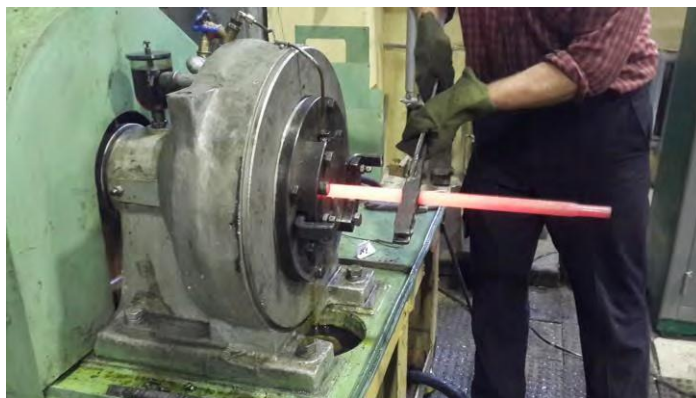
Рисунок 3- Ковка прутка никелида титана диаметром 18 мм на РКМ-1
