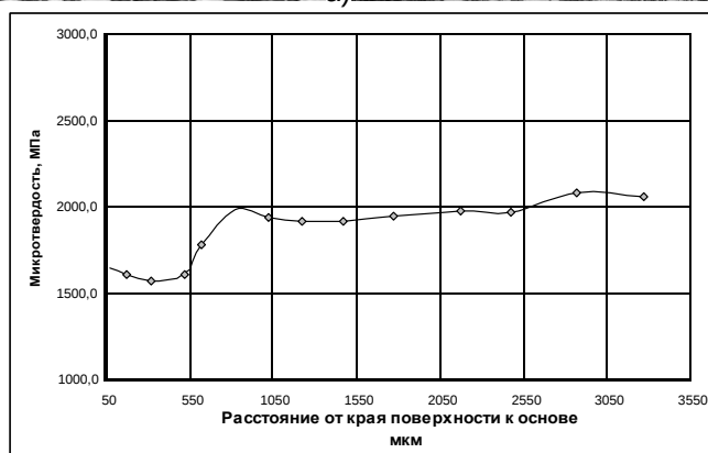
Рисунок 2 – Образец № 10 Cu, Al (6%), Al_2O_3 (25%), отжиг 200 °С, 6 часов (рег.№ 10943) а), б) микроструктура, \times 100 , \times 200 ; в) график микротвердости
