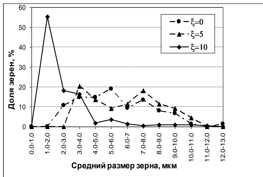
Рисунок 9 – Структура СВС-продукта при составе шихты Ti-2B: а – микроструктура (сканирующая электронная микроскопия) при \xi = 2 мкм, б – гистограмма среднего размера зерна для различных амплитуд УЗК
