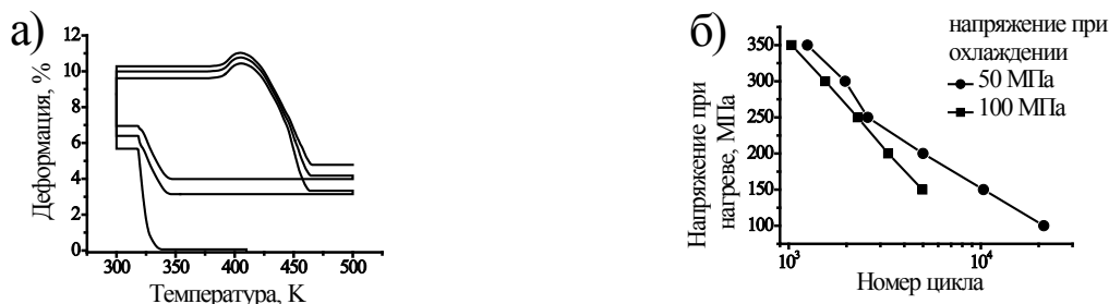
Рисунок 2 - Схема мягкого рабочего цикла (а), число циклов до разрушения в зависимости от напряжения при нагреве в мягком цикле (б).
