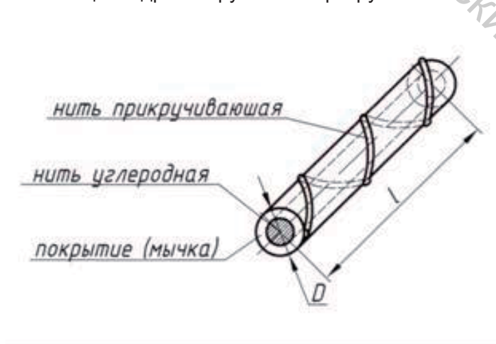
Рисунок 2 - Схема комбинированной углеродной нити
