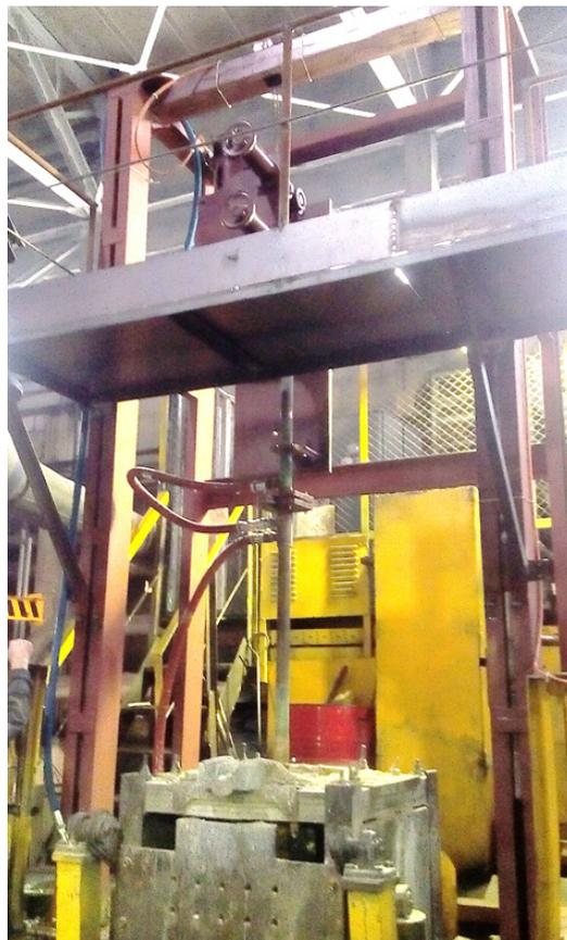
Рисунок 2 - Установка непрерывного литья вверх на КУЗОЦМ
