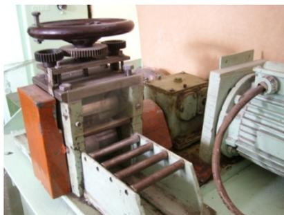
Рисунок 1 - Общий вид установки для исследований дефекта «вкатанная окалина»
