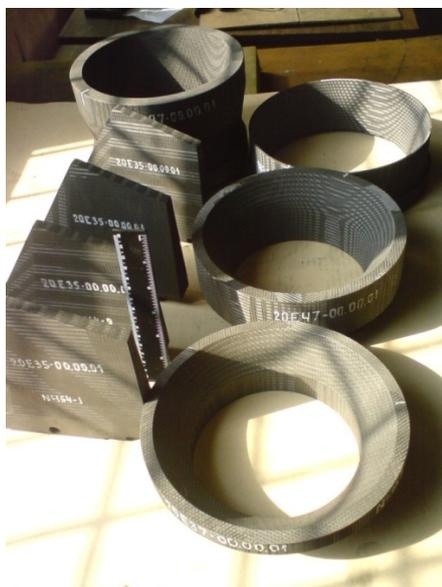
Рисунок 1 - Общий вид деталей из объёмно-армированного УУКМ
