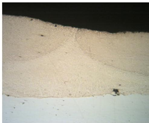
Рисунок 2- Поперечное сечение мультимодального полосчатого покрытия  $\times 50$
