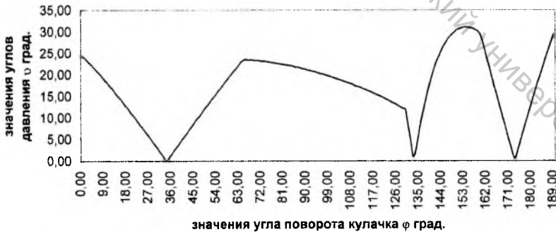
Рис. 5. Зависимость углов давления от угла поворота кулачка
