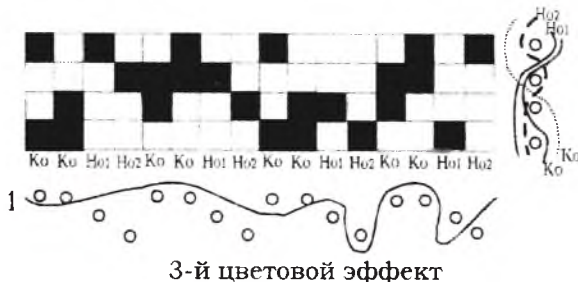
Рисунок 24. Модельные переплетения для насечки карт трехсноровой ткани.
