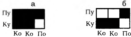
Рисунок 50. Модельные переплетения для насечки карт.
