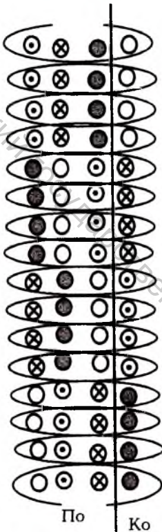
Рисунок 35. Продольный разрез одностороннего 4-х уточного гобелена.
