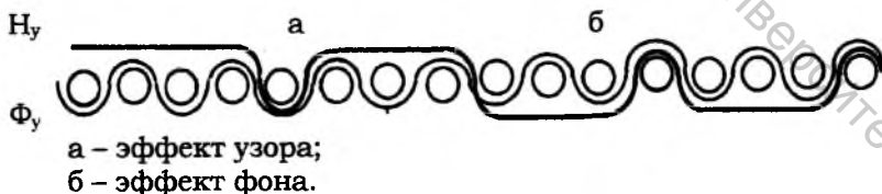
Рисунок 2. Поперечный разрез двухуточной ткани.
