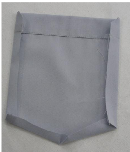
Рисунок 3.34 – Обработка боковых и нижней сторон накладного кармана с помощью шаблона
