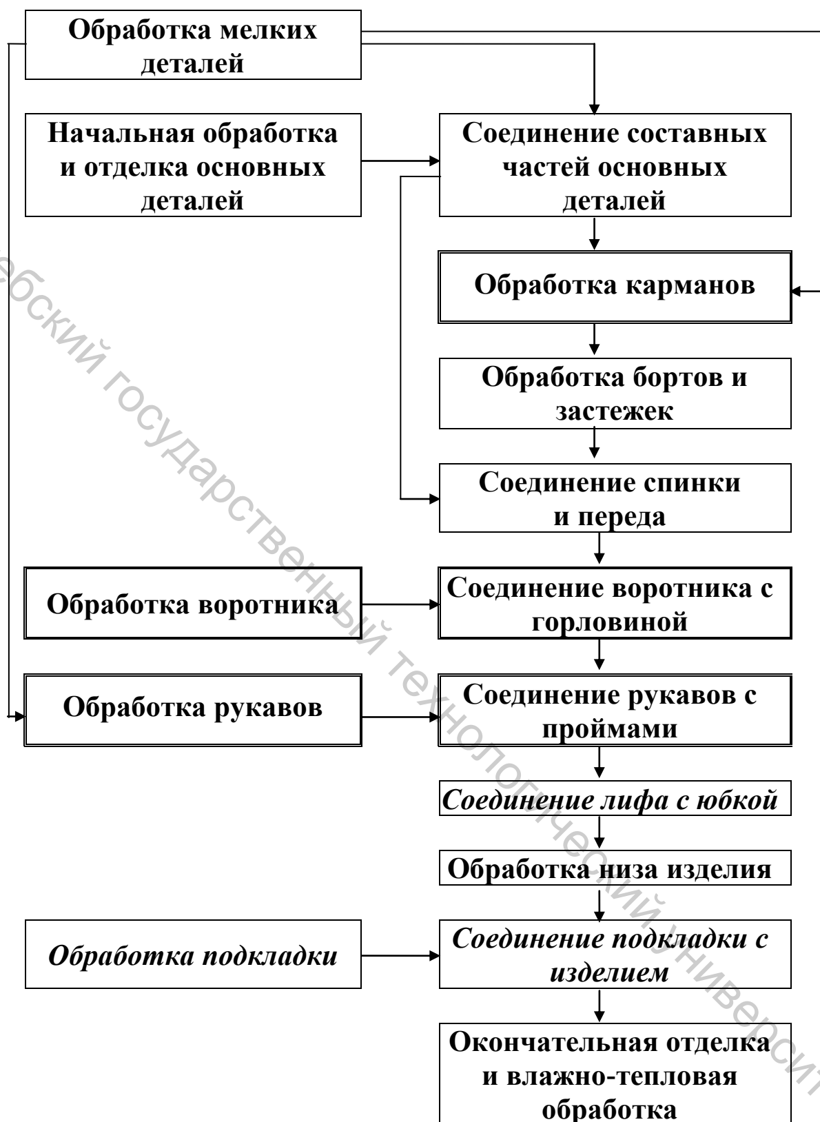
Рисунок 1.1 – Общая схема обработки и сборки узлов женского платья блузок и верхних сорочек
