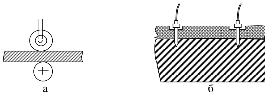
Рисунок 8.1 – Датчики: а – роликовые, б – игольчатые
