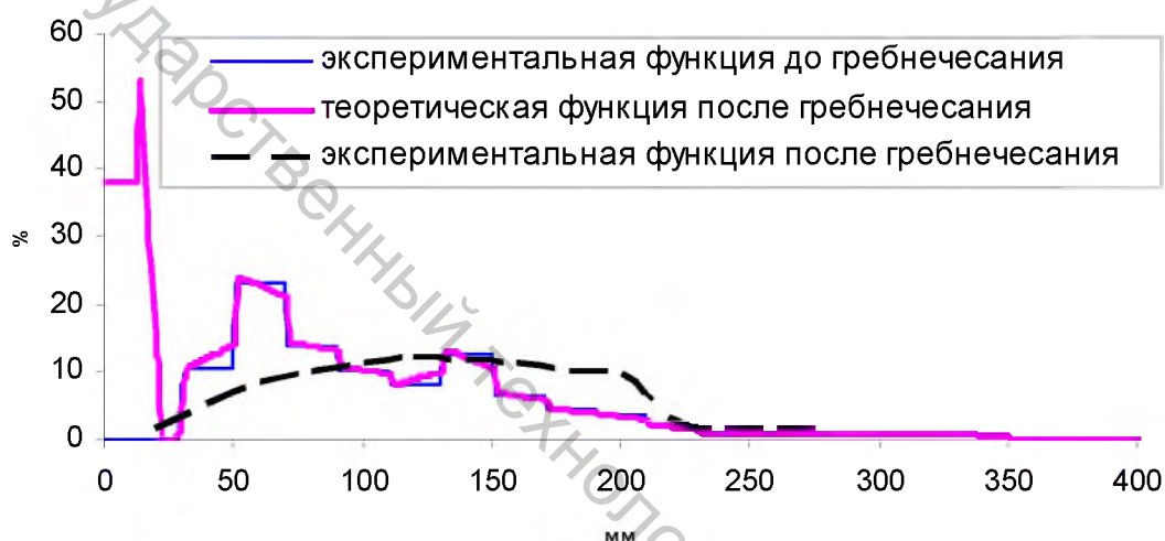
Рисунок 2 – Функции распределения льняных волокон по длине до и после гребнечесания
