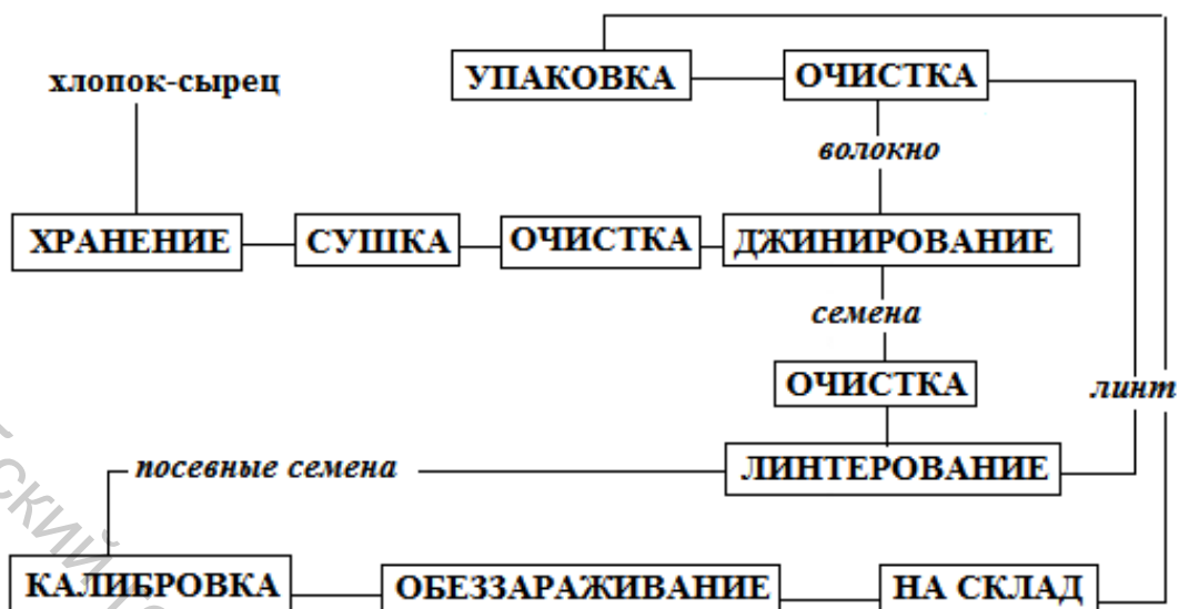
Рисунок 4 – Технологический процесс переработки хлопка–сырца на хлопкозаводе
