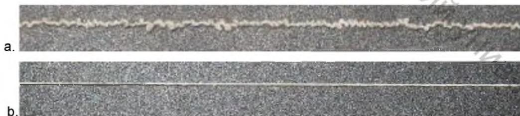
Рисунок 6 – Высокорастяжимая пряжа пневмомеханического способа прядения: а) в свободном состоянии; б) в натянутом состоянии
