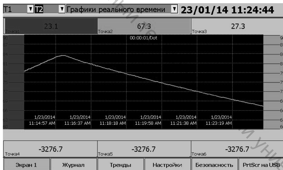
Рисунок 6.2 – График изменения температуры пластины от времени, полученный во время проведения испытаний
