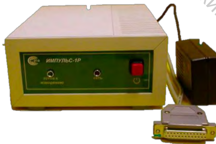
Рисунок 8.2 – Общий вид установки: 1 – блок АЦП, 2 – датчик, 3 – измерительный кабель, 4 – интерфейсный шлейф, 5 – сетевой шнур.
