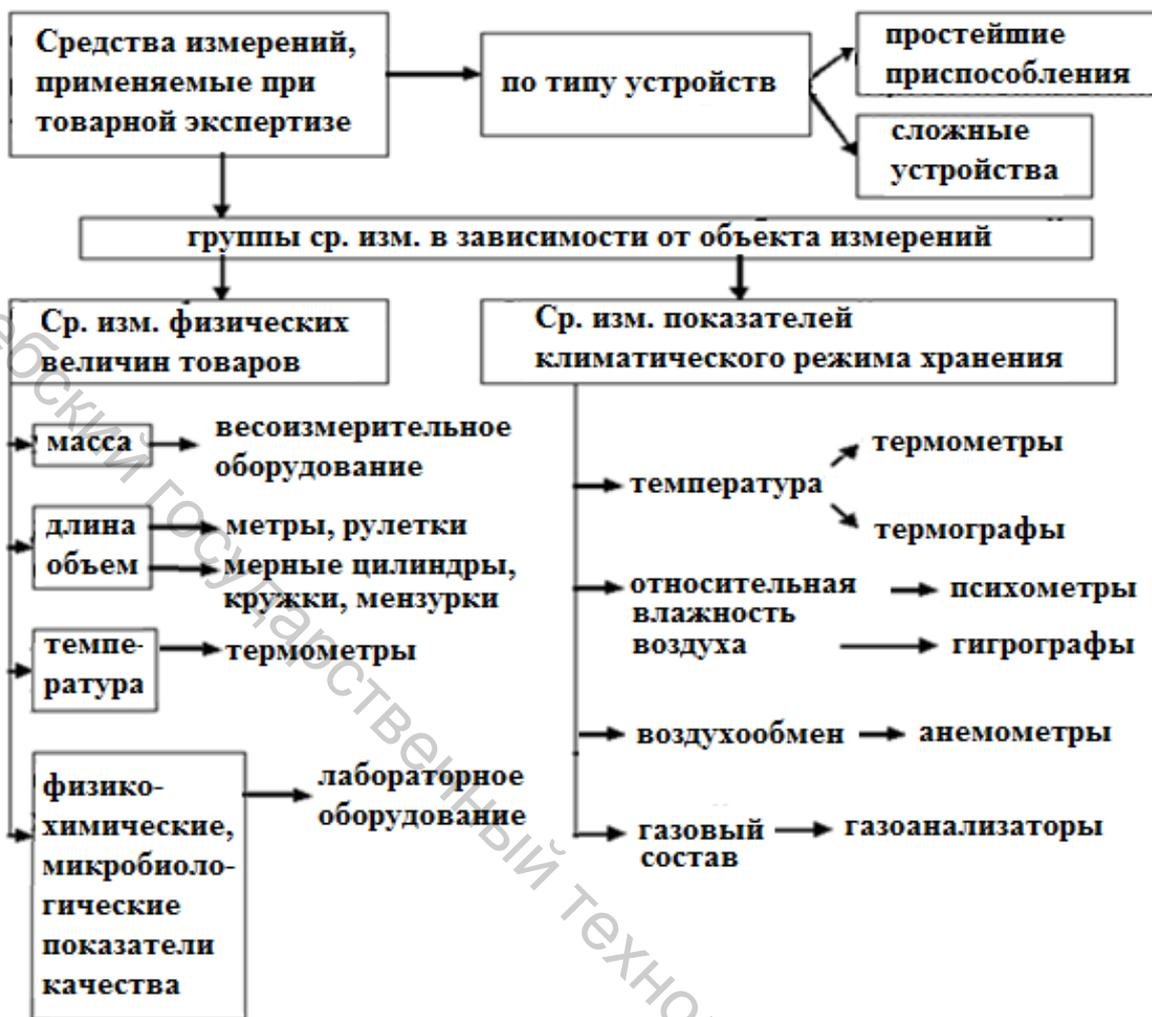
Рисунок 3.1 –Классификация средств измерений, применяемых при товарной экспертизе
