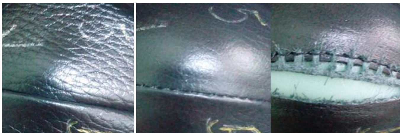
Рисунок 2 – Внешний вид тачного шва при сострачивании образцов (игла PCL, шов без упрочнения):
