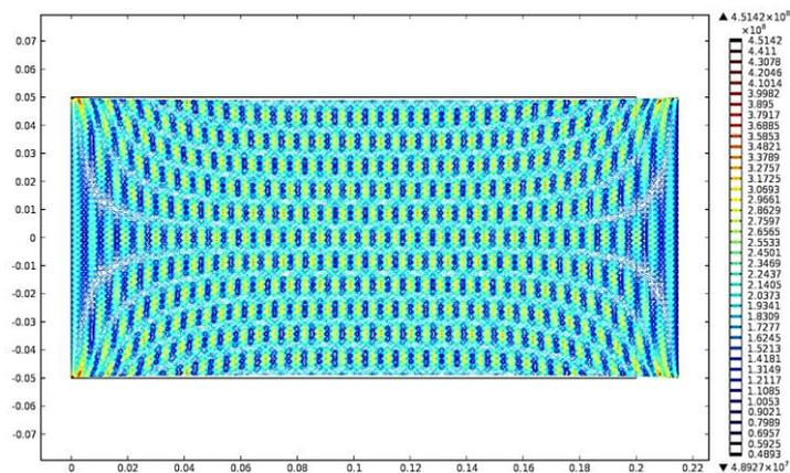
Рисунок 1 – Контуры равных механических напряжений по фон Мизесу
