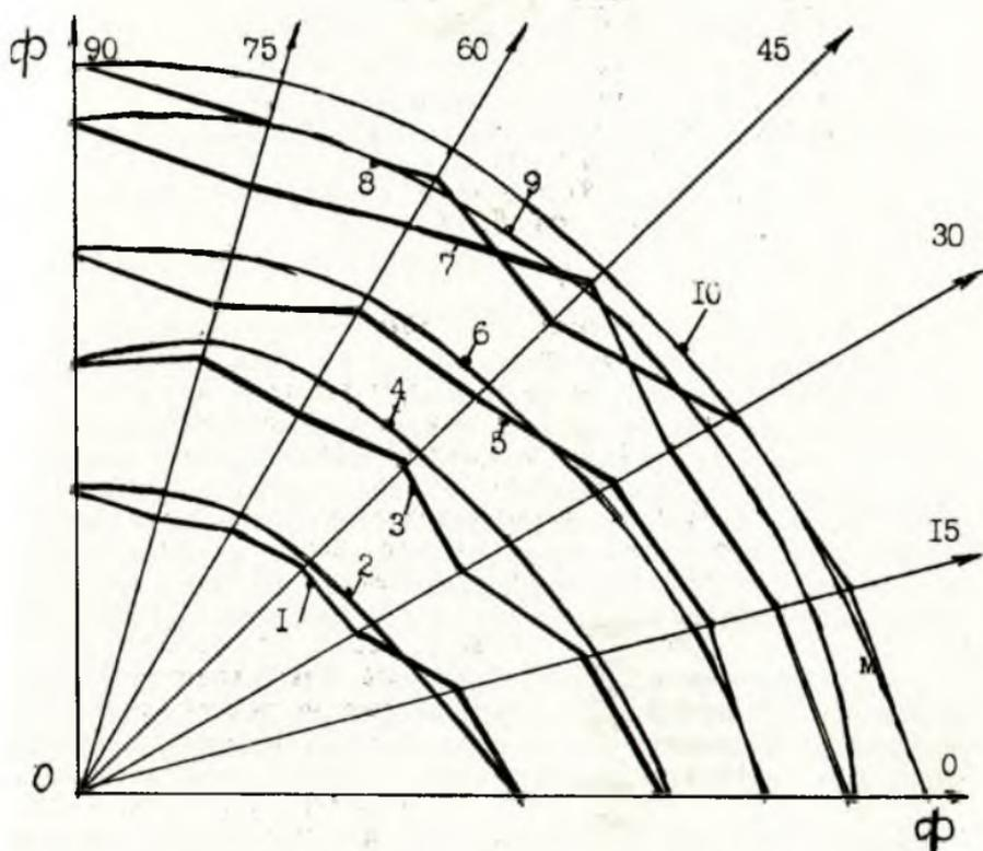
1,3,5,7,9 - экспериментальные кривые соответственно при  $\sigma^0_1 = 5$  Мпа,  $\sigma^0_3 = 10$  Мпа,  $\sigma^0_5 = 15$  Мпа,  $\sigma^0_7 = 20$  Мпа,  $\sigma^0_9 = 25$  Мпа.
