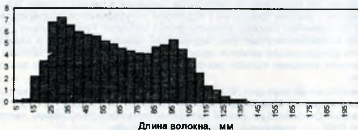
Рис. 1. Расчетная диаграмма распределения по длине волокон после первого этапа смешивания
