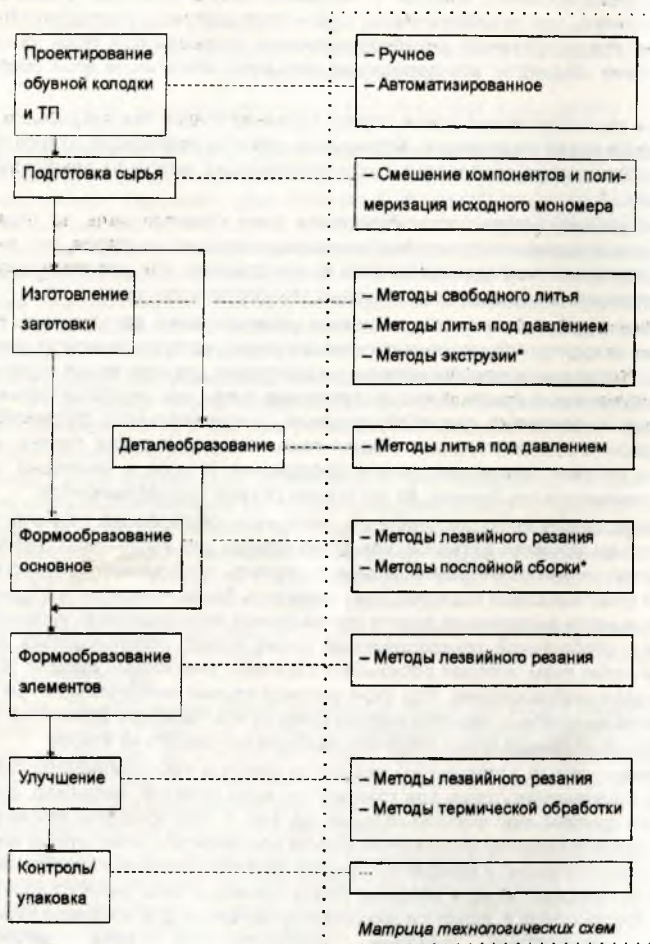
Рис. 1. Вариант типовой технологической схемы и матрица технологических схем для полиэтиленовых обувных колодок
