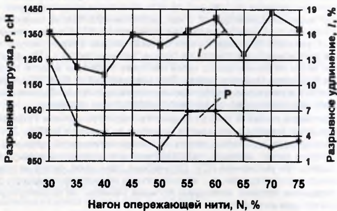
Рис. 3. Диаграммы зависимости разрывных нагрузки и удлинения ПТН в зависимости от нагона опережающей нити.
