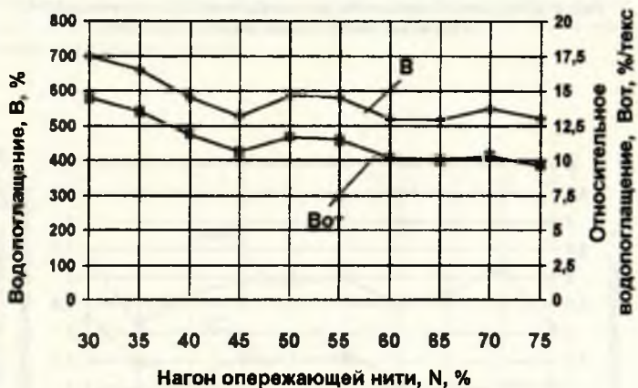
Рис. 2. Диаграммы зависимости водопоглащения и относительного водопоглащения ПТН в зависимости от нагона опережающей нити.
