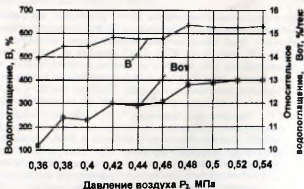
Рис. 1. Диаграммы зависимости водопоглощения и относительного водопоглощения ПТН в зависимости от давления воздуха в ПТК P_2 .
