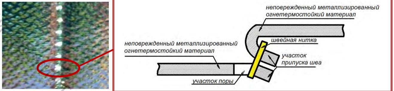
**Рисунок 1. – Внешний вид и структурная схема перфорированного участка соединительного стачного шва**
