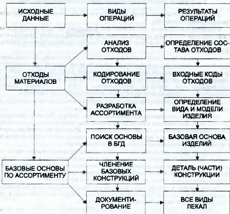
Рис.2. Структурная схема процесса проектирования новых моделей изделий из отходов текстильных материалов
