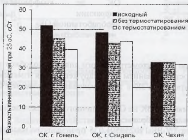
Рис. 6. Влияние УЗК обработки на кинематическую вязкость ОК
