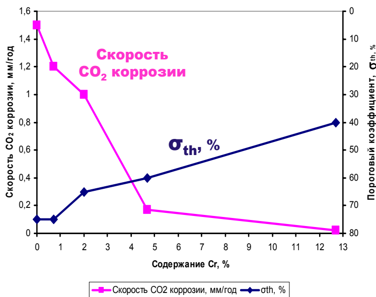
Рис. 1. Зависимость коррозионной стойкости исследуемых сталей от содержания Cr (углекислотная коррозия)
