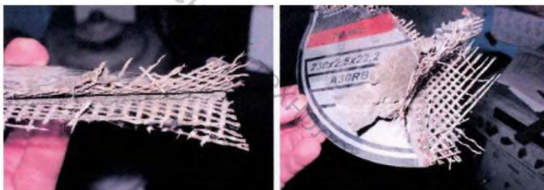
Рисунок 2 – Состав и вид разрушения диска
