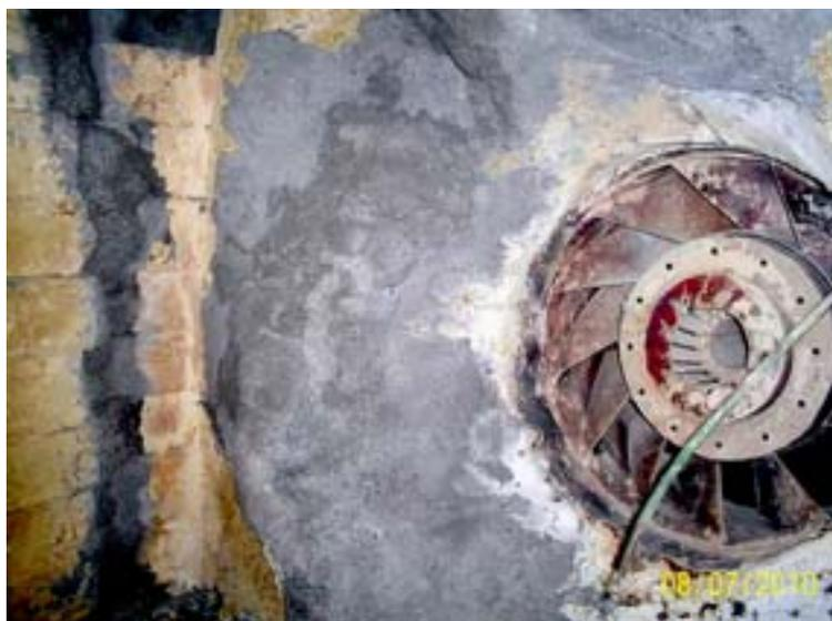
**Рис. 2.** Вид покрытия, нанесенного на поверхность горелочного камня после 7 суток непрерывной работы печи
