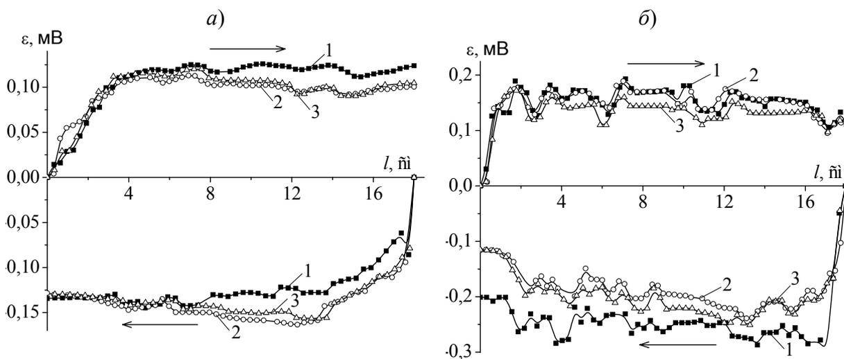
**Рис. 1.** Зависимость распределения термокинетической ЭДС по длине образца для проволоки диаметром 0,48 мм (а) и 0,22 мм (б)
