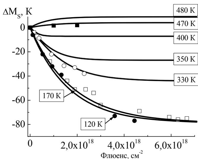
ставлены результаты измерений, а линиями данные расчетов. Результаты компьютерных расчетов удовлетворительно совпадают с экспериментальными данными и позволяют прогнозировать поведение сплава при облучении в широком интервале температур от 120 К до 480 К флюенсом быстрых нейтронов до  $7 \cdot 10^{18} \text{ см}^{-2}$ .
