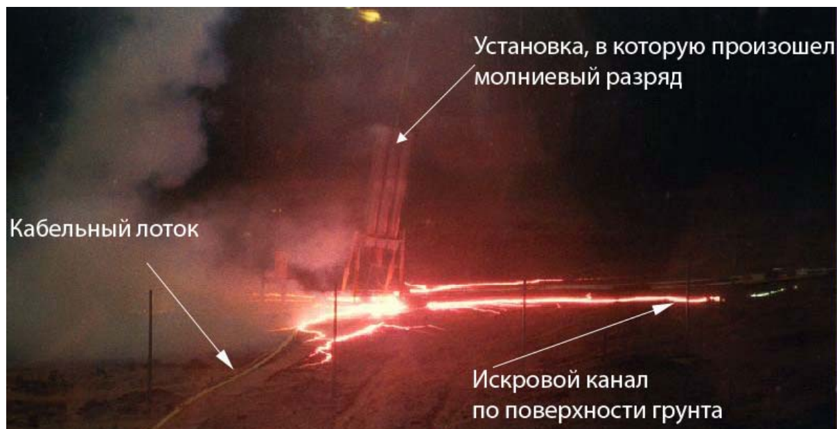
Рис.4. Развитие искрового канала на грунте при молниевом разряде.
