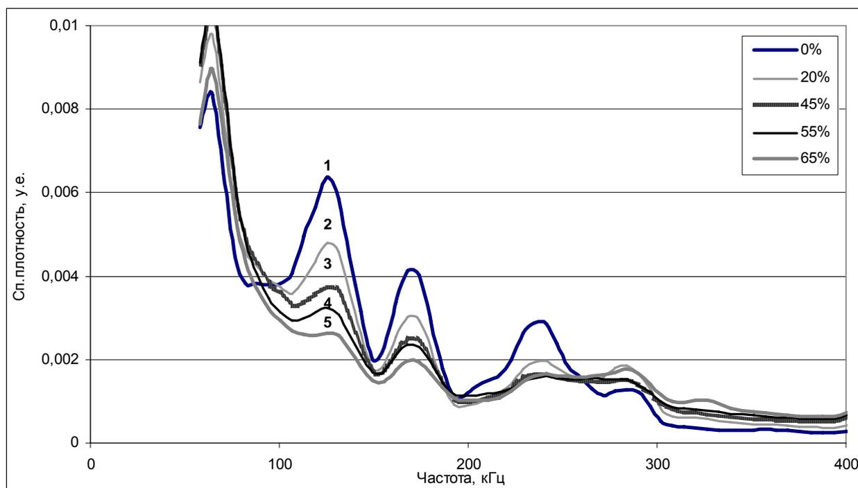
**Рис. 3.** Спектральные портреты сигналов АЭ при индентировании технического титана в исходном состоянии (1) и после БКД на 20 (2), 45 (3), 55 (4) и 65% (5)
