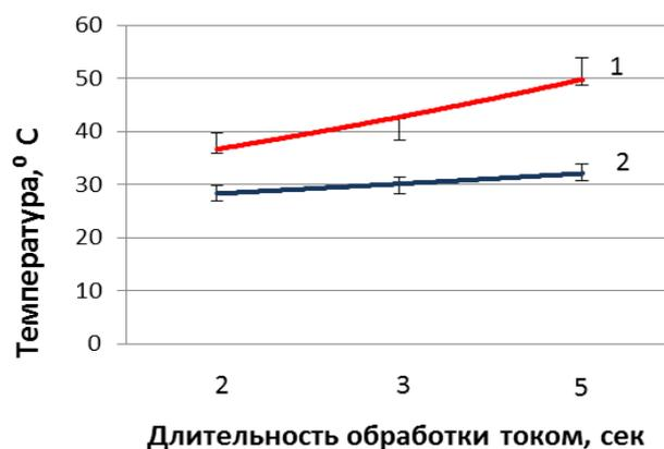
**Рис. 3.** Тепловой эффект в сплаве Д16 , прокатанном с током (кривая 1) и без тока (кривая 2)
