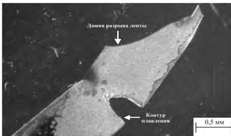
Рис. 4. Фотография образца АМАГ-186 прошедшего испытание на ползучесть. Стрелками отмечены линия разрыва ленты и контур незавершенного плавления.
