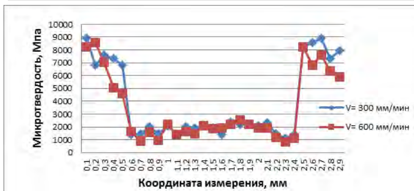
Рис. 6. Распределение микротвердости в композиционном покрытии по ширине плазменного покрытия из бронзы ПГ-19М-01 при мощности плазменного напыления 14300 Вт
