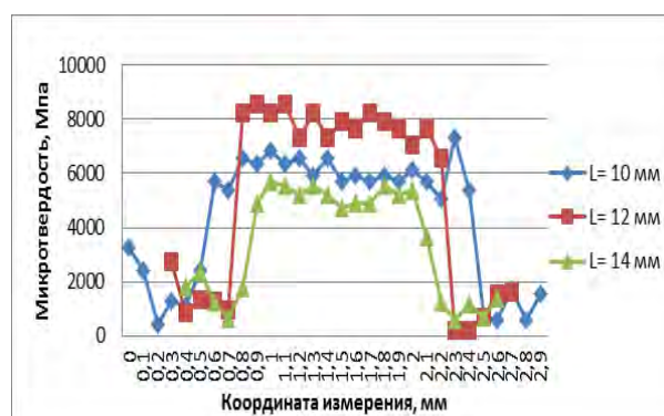
Рис.3. Распределение микротвердости в композиционном покрытии по ширине наплавленных валиков из сплава ПГ-12Н-01 при скорости лазерной наплавки V = 80 мм/мин
