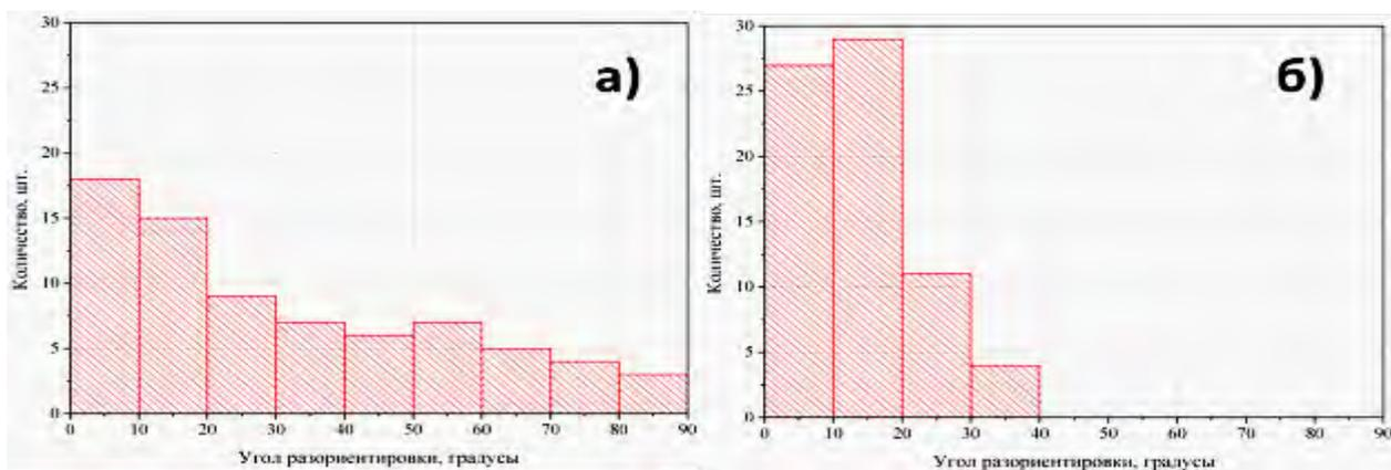
**Рис. 4.** Распределения углов разориентировки фасеток в изломах: а) – образца, разрушенного при  $-196\text{ }^{\circ}\text{C}$ , б) – образца, насыщенного водородом
