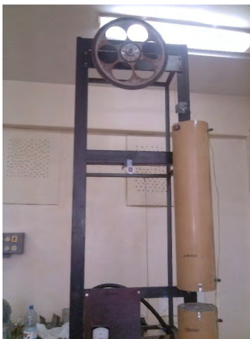
Рис. 1. Установка для получения гибкого абразивного шнура
