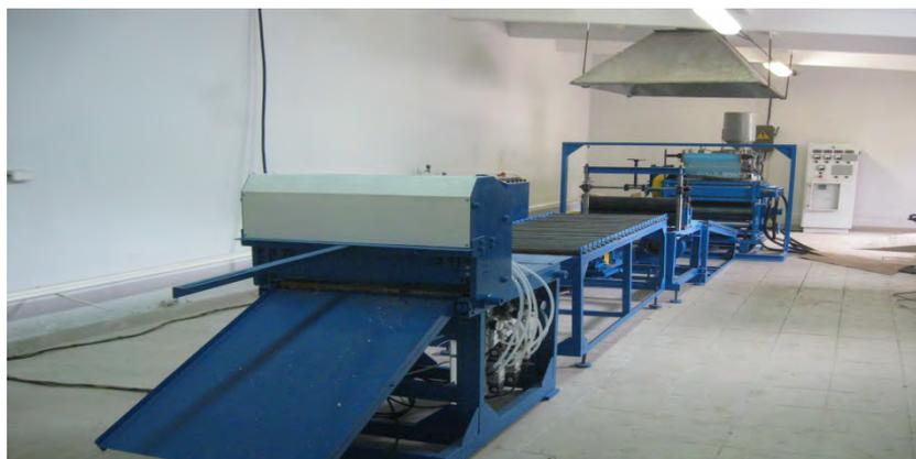
Рис. 1. Линия для изготовления листовых материалов из полимеров
