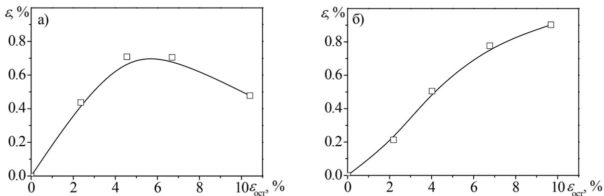
**Рис. 2.** Зависимости обратимой деформации от остаточной деформации, полученные в биметалле “Ti<sub>50</sub>Ni<sub>50</sub> – Ti<sub>49,3</sub>Ni<sub>50,7</sub>” с оптимальным соотношением толщин, отожженным при температуре 600 °C (а) и 450 °C (б).
