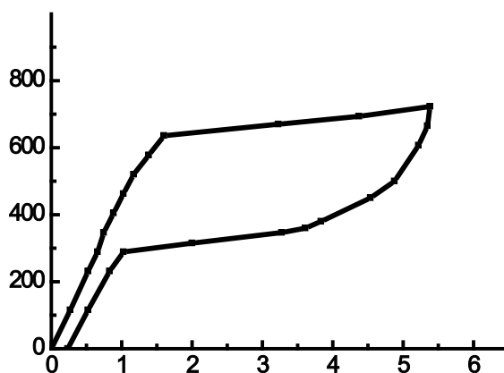
Рис. 3. Диаграмма деформирования дилататора из TiNi сплава
