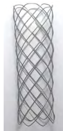
Рис. 1. Рабочий элемент дилататора из сплава TiNi
