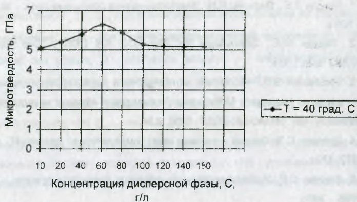
Рис. 1. Зависимость твердости покрытия от концентрации дисперсной фазы в электролите
