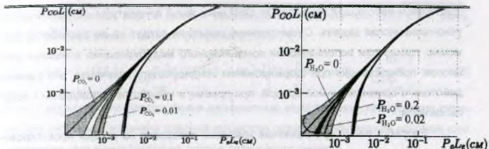
Рис. 6. Результаты определения СО при разных концентрациях  $\text{CO}_2$ , и  $\text{H}_2\text{O}$
