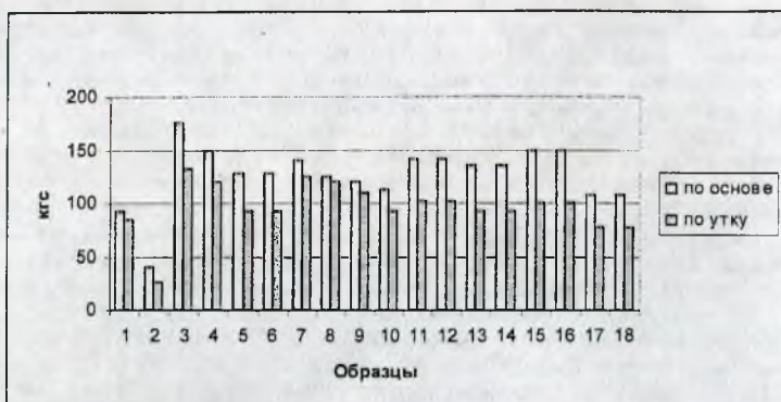
Рисунок 2 – Данные о прочности на разрыв тканей-аналогов
