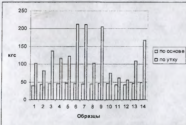
Рисунок 1 – Результаты испытаний прочности на разрыв наработанных образцов
